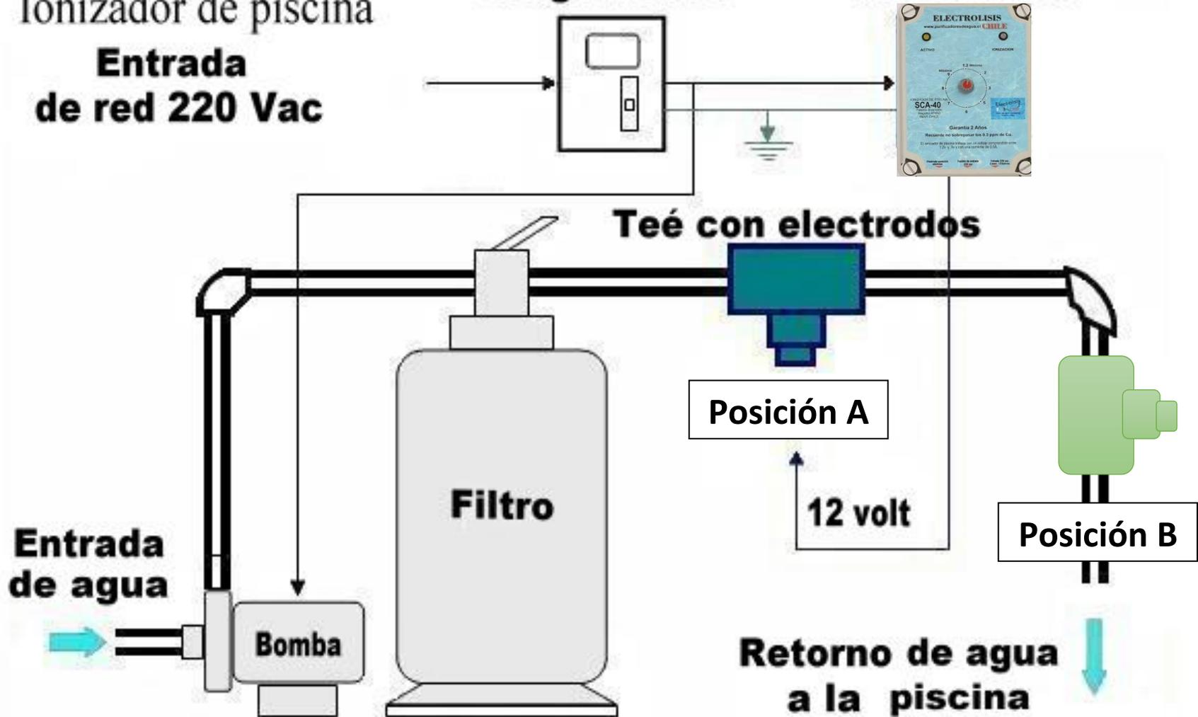
**La teé se puede instalar en la posición A o en la Posición B**
